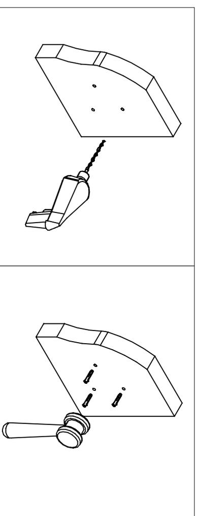
03 Fixar a Base do Suporte (02) com os parafusos (A) na parede como mostra a ilustração. Após fixar a base do Suporte no Teto, exerça um peso de aproximadamente 10kg para garantir se o teto irá sustentar o peso do conjunto montado. Obs: Caso tenha dúvida da resistência de sua parede, consulte um técnico profissional da área.
