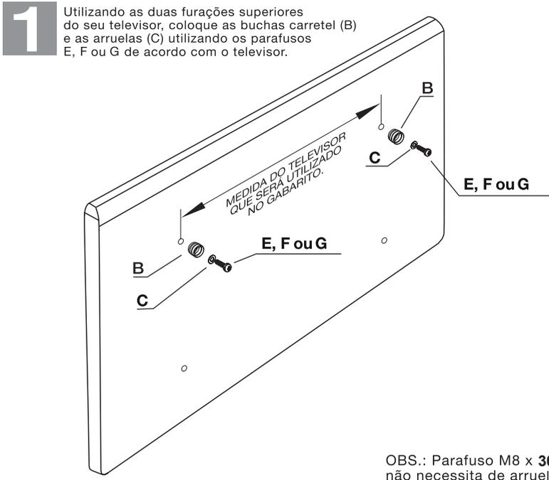
OBS.: Parafuso M8 x 30 (E) não necessita de arruela (C)
