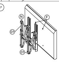
(4°) Fixe as Hastes n°01 no televisor utilizando os parafusos q melhor se adaptarem à ele (I, J, K, L, M, N ou O), arruelas (C,D ou E) e espaçadores (F ou G) como mostra a ilustração.
