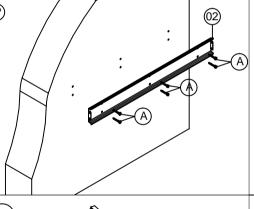
Fixar a Chapa de parede Suporte (02) com os parafusos (A) na parede como mostra a ilustração. Novamente utilize o nível para se certificar que a instalação fique correta. Após fixar a
