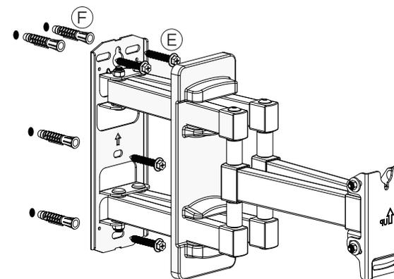
2º. Inserte los casquillos (F) en los orificios y asegure el soporte con los tornillos (E). Asegúrese de que el soporte esté firmemente contra la pared. En caso de Si tiene alguna duda, consulte a un experto.
