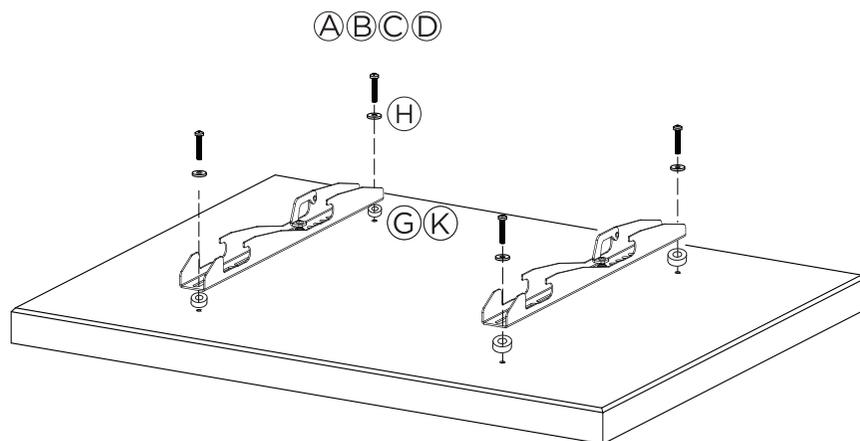
3º. Coloque las ② varillas en el televisor. Compruebe cuál de los tornillos (A), (B), (C) o (D) se adapta a su televisor. Utilice espaciadores (G) o (K).
